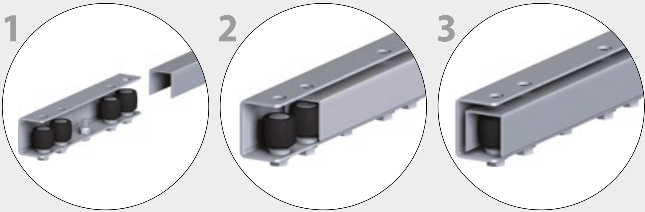
Vista sezione profilo guida kit telescopico Sectional view telescopic kit guide profile
